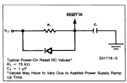
Figure 3. Power-On Reset Circuit
