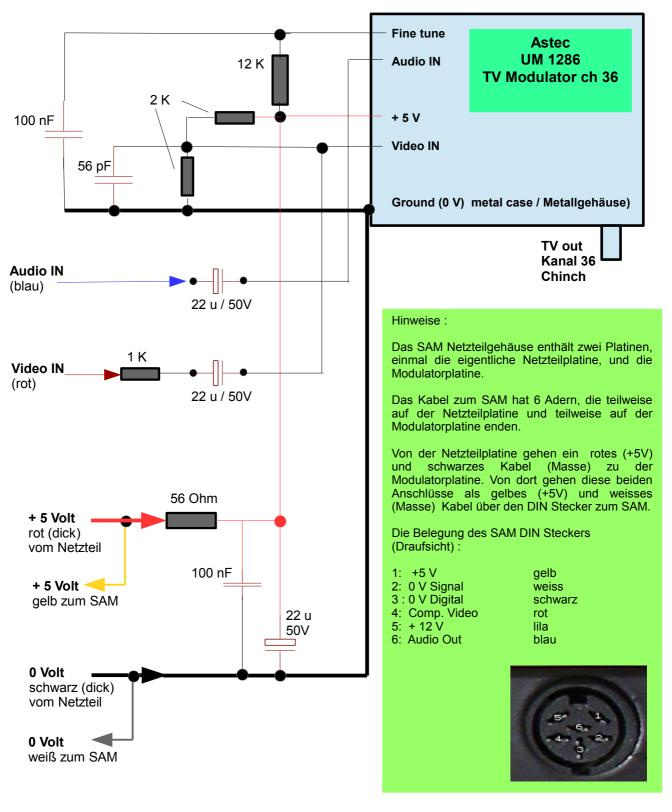
TV Modulator für MGT SAM Coupe mit Astec UM 1286 Modulator Kanal UHF 36
